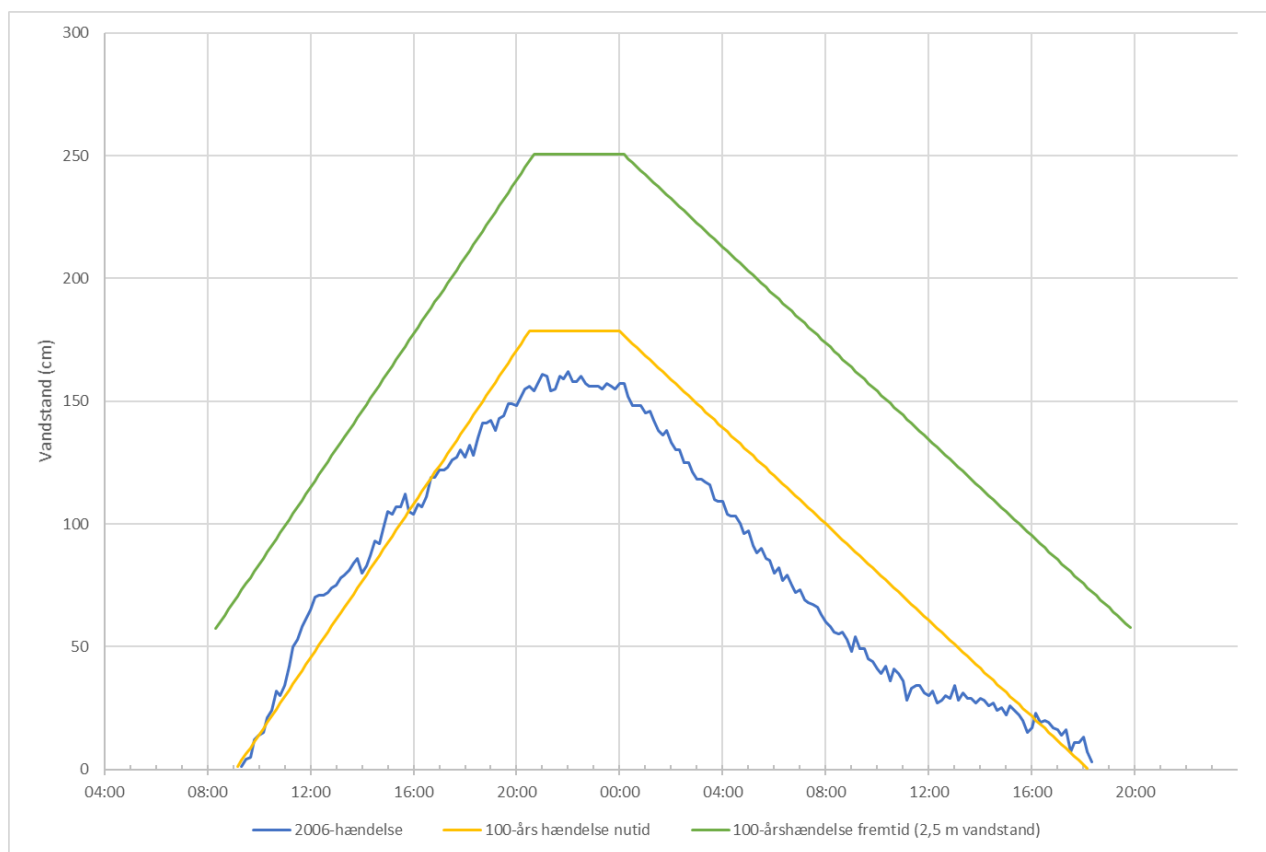
Figur 4-3: Stormflodsforløb for designstormflod – skalering med reference til november-2006-stormen
