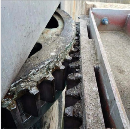
Figur 7-7: Princip af kraftoverførelsen mellem et tandhjul og en tandstang.
