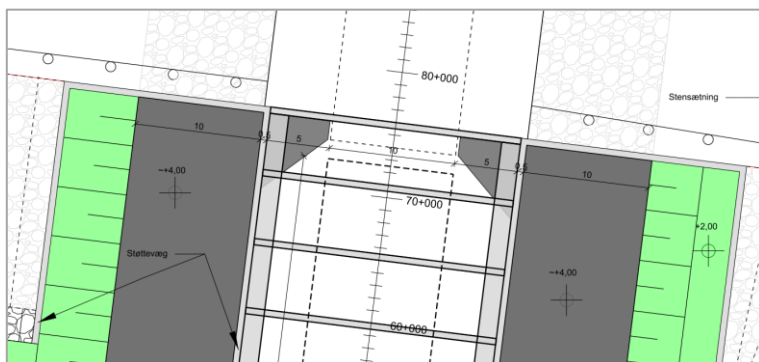
Figur 6-6: Åbning i portkammer. Udsnit af tegning NSS-D-TH-1101 i bilag 1
