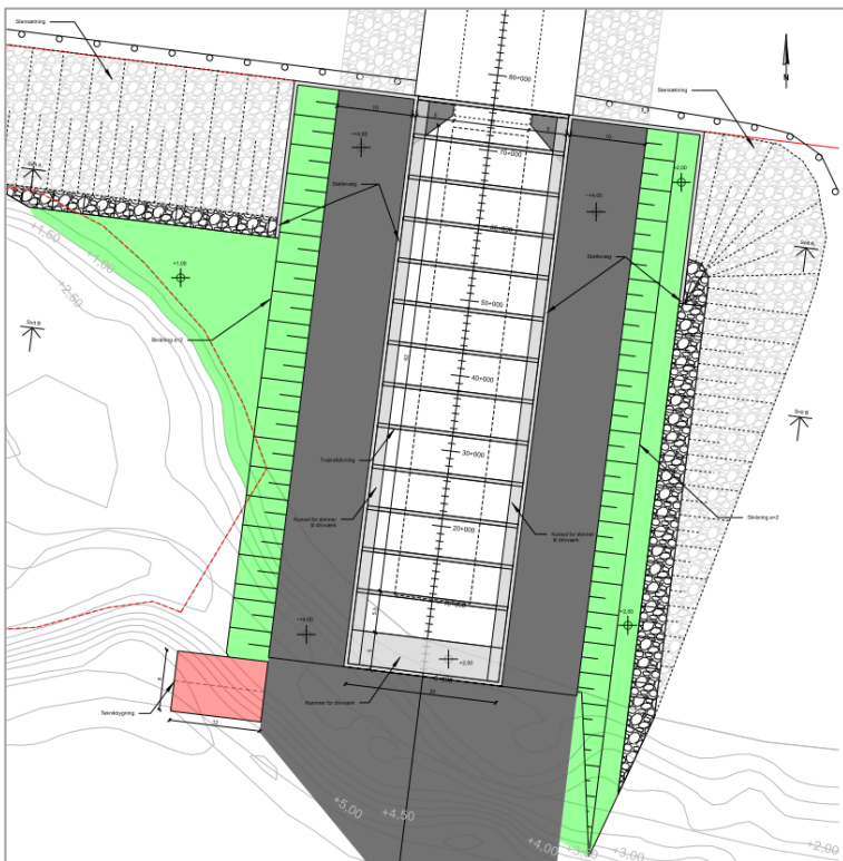
Figur 6-3: Sydligt landanlæg, se tegning NSS-D-TH-1101 i bilag 1.
