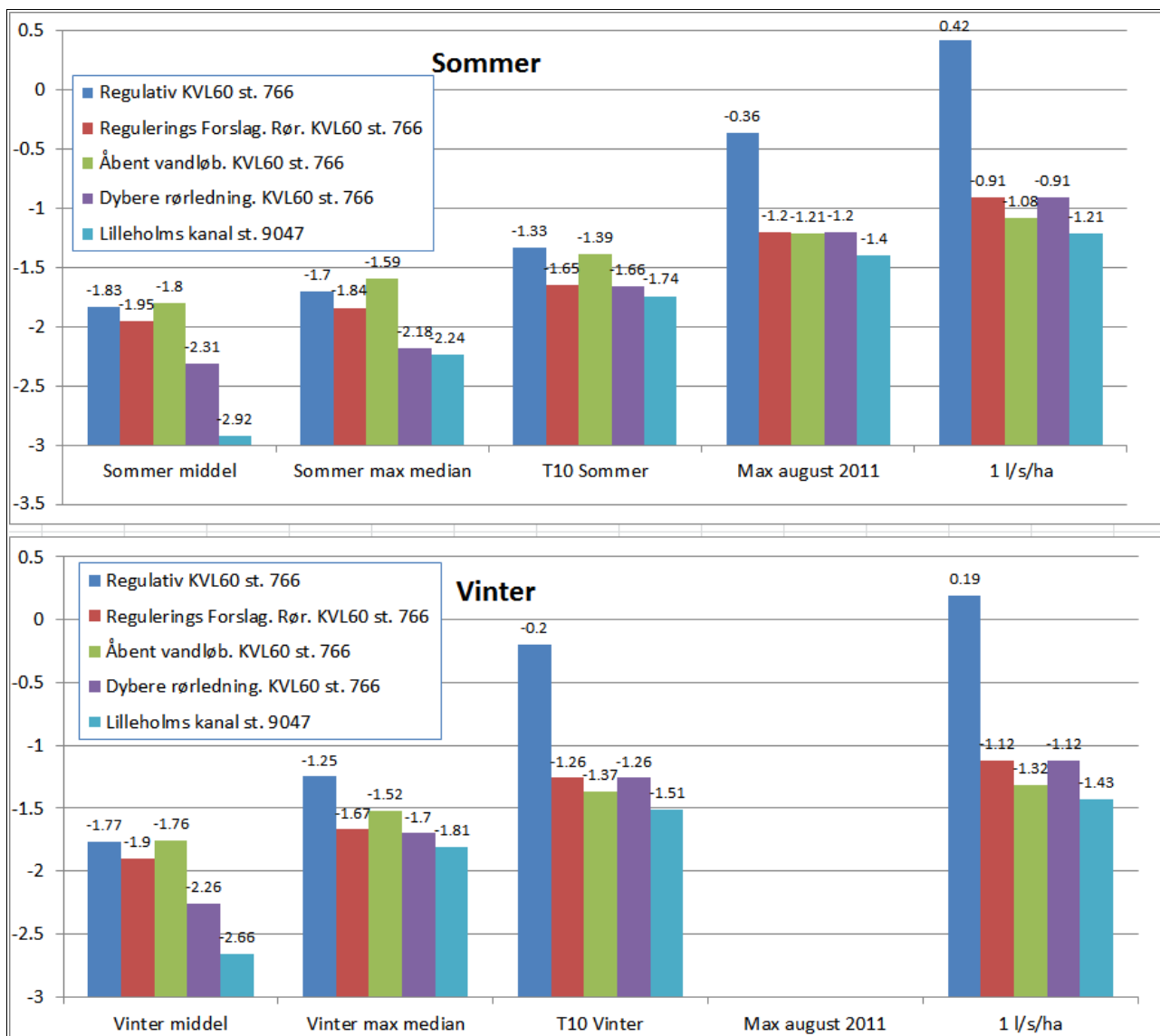
Figur 11: Beregnede vandstande/trykhøjder ved indløb af drænsystem fra Hummingen (KVL60 st. 776) for forskellige alternative udformninger af KVL60 ved forskellige afstrømningshændelser. Yderligere er beregnede vandstande i Lilleholms kanal ved tilløb af KVL60 vist. Terrænkoten ved station 776 er omkring -0,4m
